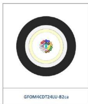
Cavo in fibra ottica di tipo dry loose (codice GFxxxCDTyyLU-B2ca)
